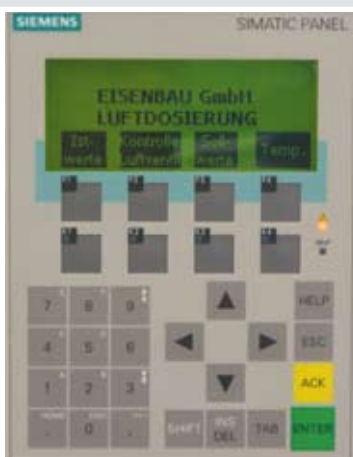
Bedienpanel mit Simatic S7-Steuerung
